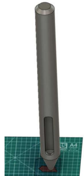
1 ) Former une demi-sphère avec un poinçon de 1mm pour les clignotant et 2 mm pour les phares
